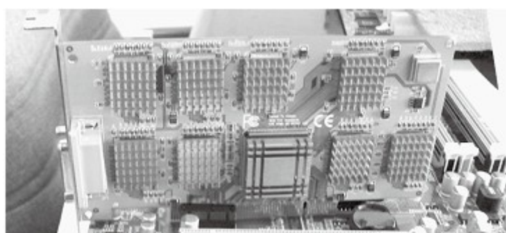
图 3: PCI-Ex1 接口的采集卡插在 PCI-Ex1 插槽上
